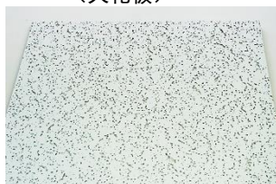
涂抹在石棉上 （天花板）
